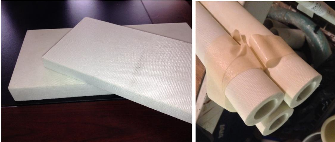
**VIDICON 10, VIDICON 11 (NEMA G-10/ G-11):** Laminado de vidrio con alta rigidez dieléctrica, utilizada ampliamente en la reparación de motores y generadores, pero también de uso común en interruptores y tableros, para uso en intemperie. **Se fabrica en placas, tubos y barras redondas.**
