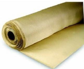
Se utiliza principalmente como alternativa a las telas de asbesto y cerámicas. Fabricada de 96% Silica pura (SiO<sub>2</sub>), perfecta para trabajo continuo hasta 982°C y permite la exposición en tiempo corto a 1650°C. La tela Silica se vende en rollos de fundas y rollos de tela.
